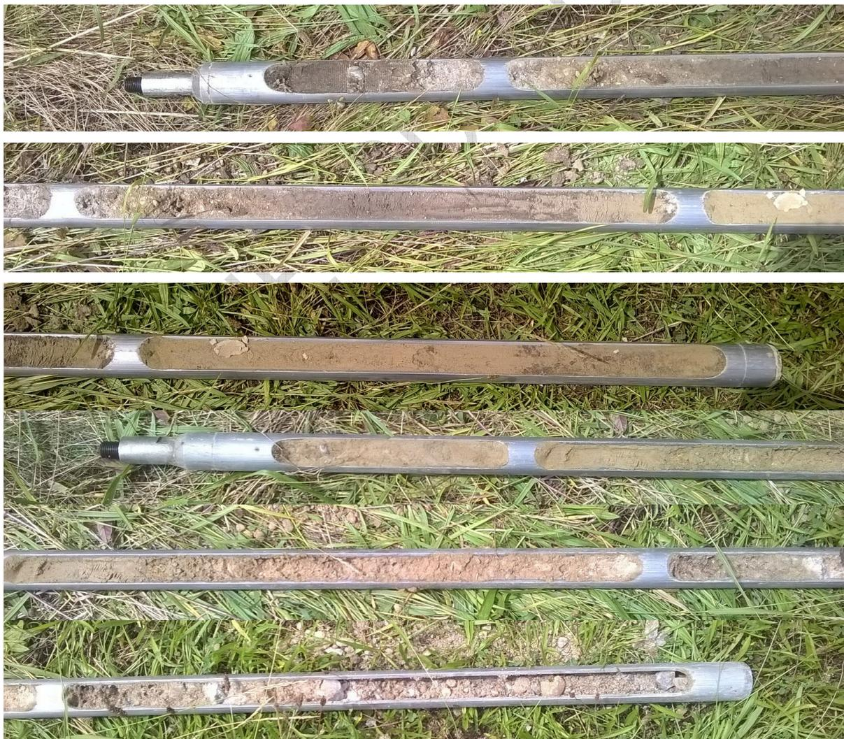
**Bild 7:** repräsentativer Bohrkern aus RKS 2 (von links nach rechts und von oben nach unten entspricht dem Verlauf von Geländeoberkante bis zur Endteufe von 0,0 m unter GOK)
