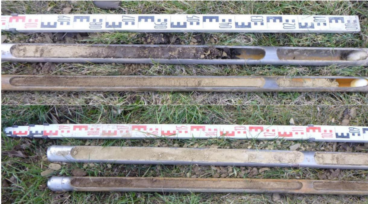
Abbildung 5: Bohrkern aus RKS 1 (von rechts nach links und von oben nach unten entspricht dem Verlauf von Geländeoberkante bis zur Endteufe von 4,00 m)
