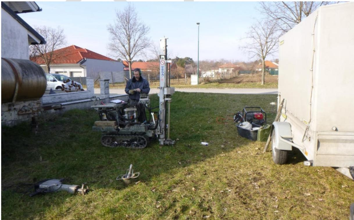
Abbildung 3: Ansatzpunkt Rammsondierung RS 1
